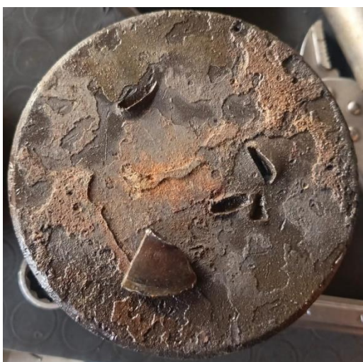
FIGURA 6. Pistón del Cilindro N°1 con fragmento de la válvula
