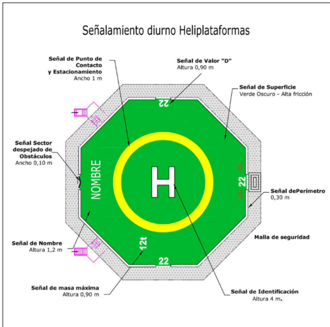
Figura A-5-8. Señalamiento de heliplataporma
