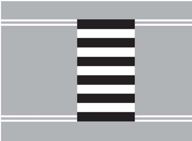
Figura C - 61 Ubicación de la señal de paso de peatones en una vía de servicio.
