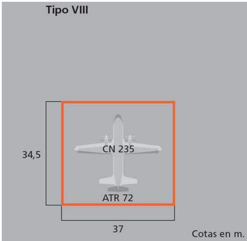
Figura C - 27 h) Configuración del puesto de estacionamiento Tipo VIII
