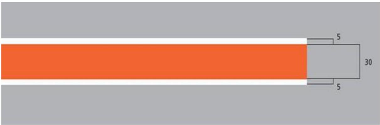
Figura C - 4 Línea de seguridad en plataforma
