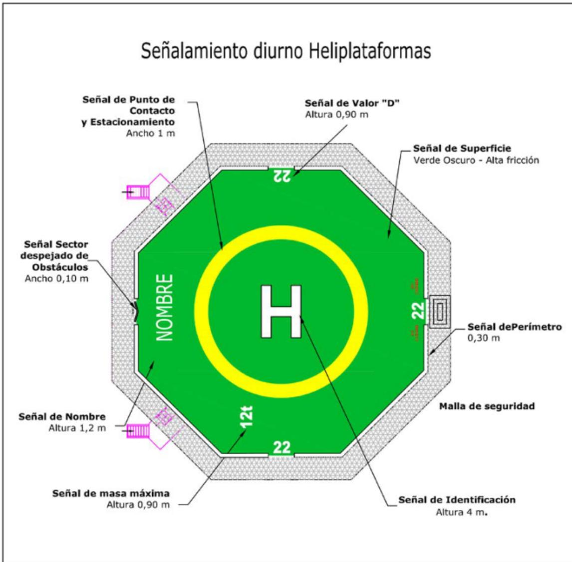
Figura A-5-8. Señalamiento de heliplataforma
