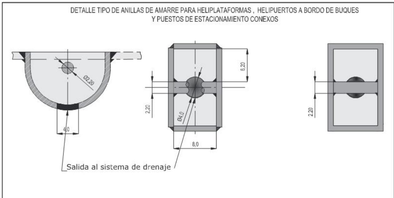
Figura A-3-9. Detalle de anillas de amarre para heliplataformas, helipuertos a bordo de buques y puestos de estacionamiento conexos
