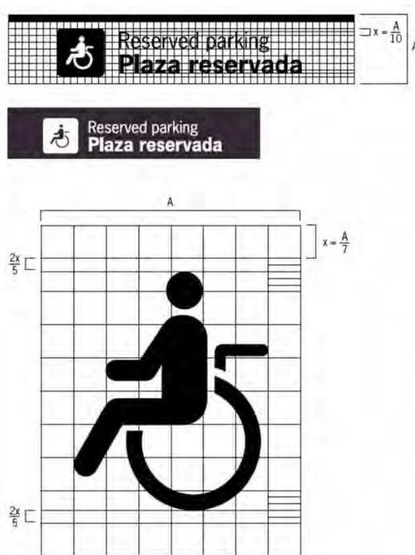
**6.1.5** La rotulación de los elementos verticales exentos, para la señalización en el exterior de los terminales, se realizará aplicando los criterios de reticulación y ordenación informativa aquí establecidos.
