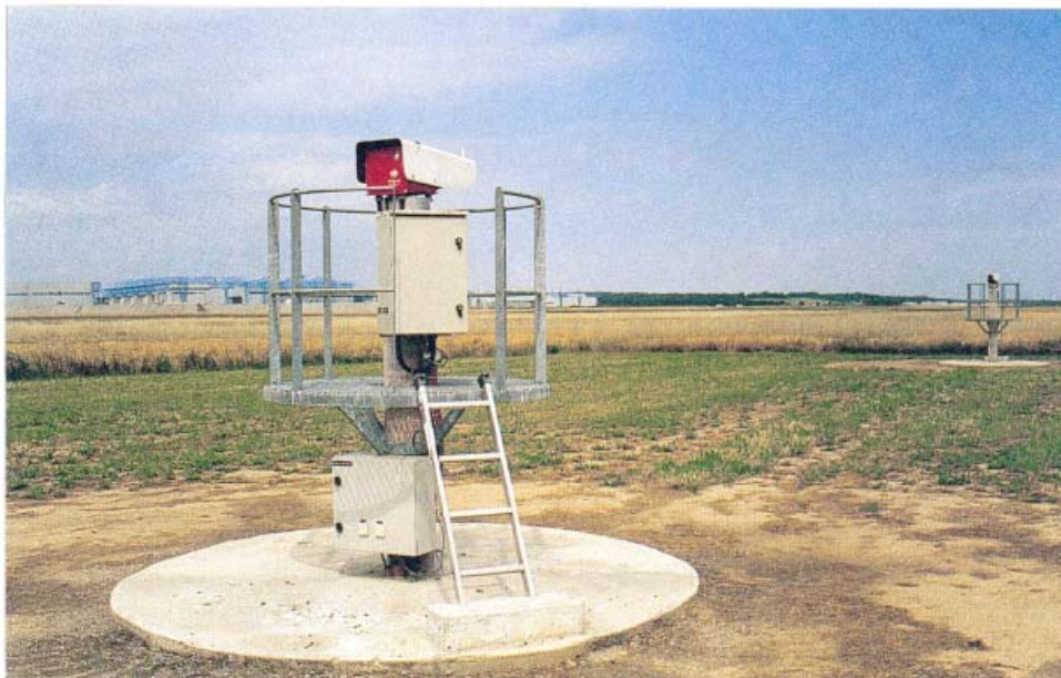
Figura 13-17 – Transmisómetros de RVR
