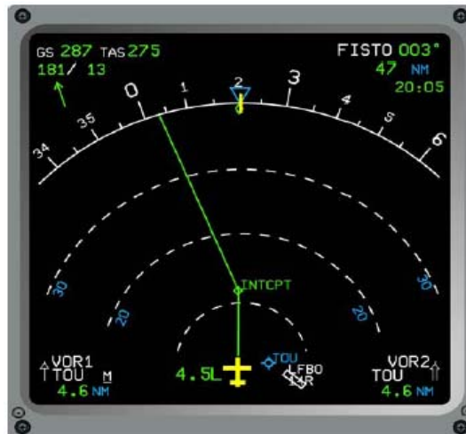
Figura 4-12 – Desviación lateral con un decimal en el ND
