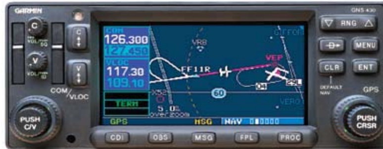
Figura 4-5 – Receptor típico GNSS autónomo (Garmin 400W-Series – WAAS GPS – TSO 146a)
