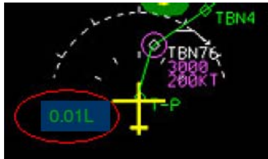
Figura 4-13 – Desviación lateral con dos decimales en el ND
