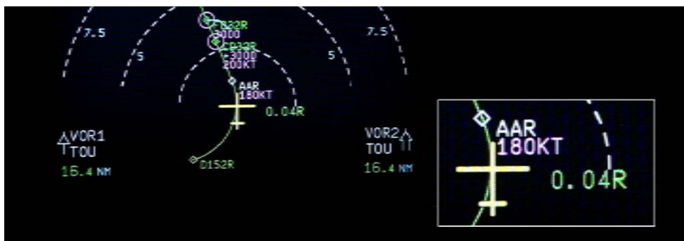
Figura 4-28 - Ejemplo de desviación lateral presentadas en el ND
