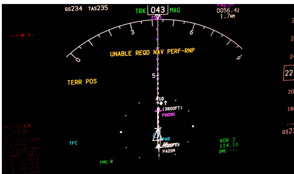
Figura 4-17B – Anuncios de alerta en el MCDU y ND de un avión A-320
