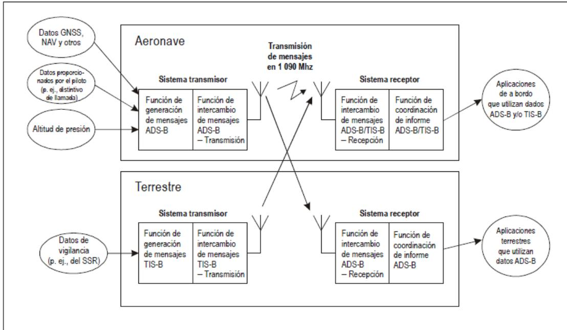
**Figura 5-1. Modelo funcional de sistema ADS-B/TIS-B**
