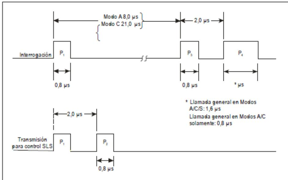
Figura 3-3. Secuencia de impulsos de interrogación en intermodo
