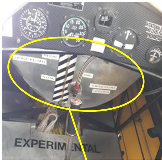
Tanque de combustible
