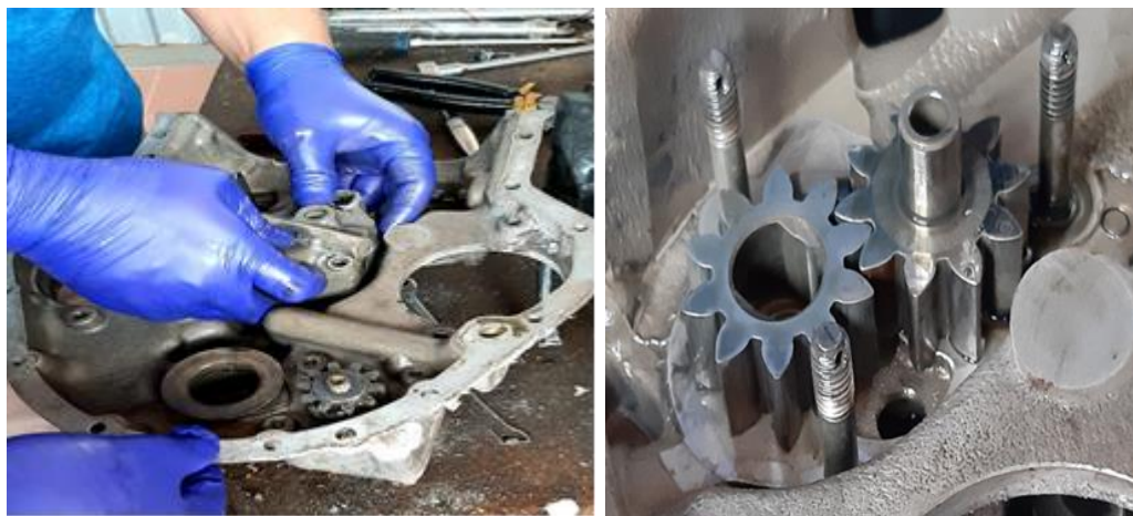
Inspección de la bomba de aceite del motor
