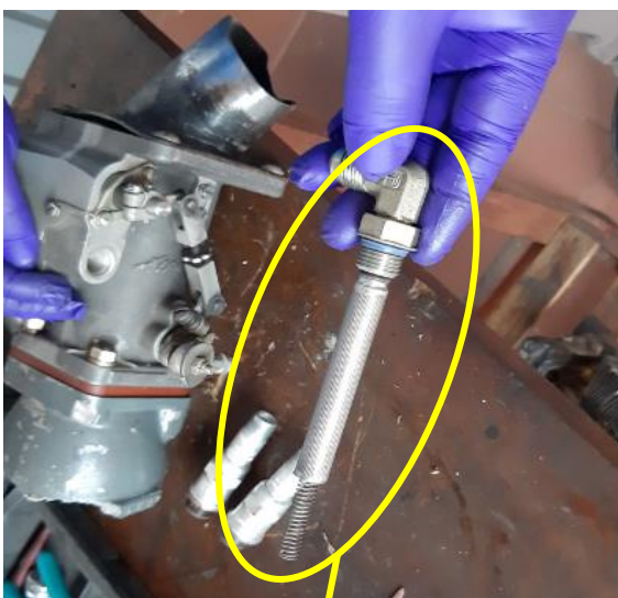
Filtro de combustible limpio
