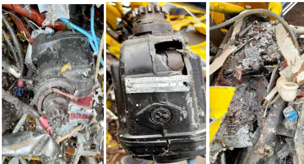
Componentes y accesorios del motor destruidos por impacto
