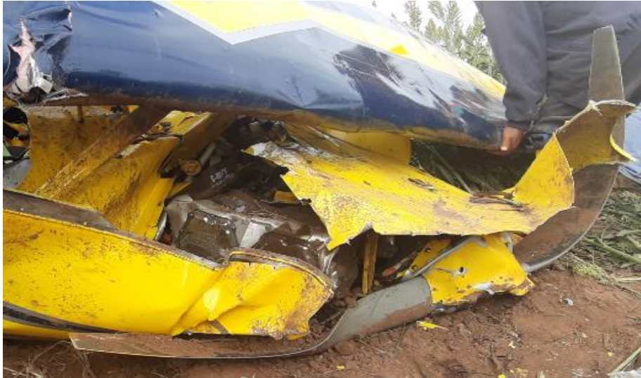
Hélice y spinner sufrieron daños de aplastamiento por impacto
