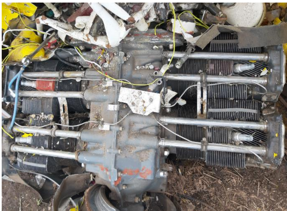
Motor antes del desarmado para inspección
