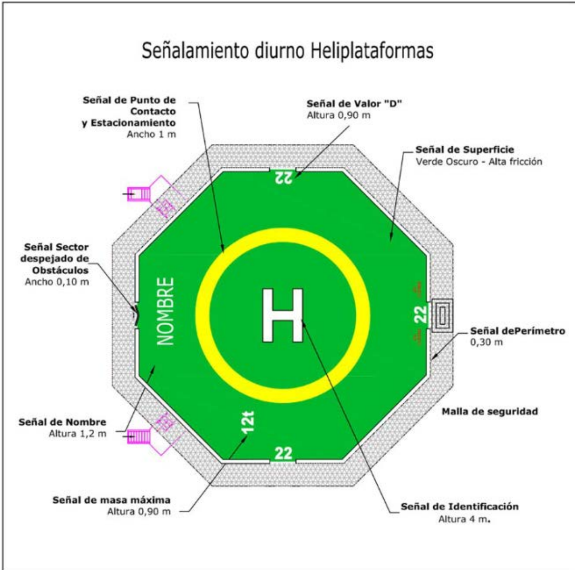
Figura A-5-8. Señalamiento de heliplataforma
