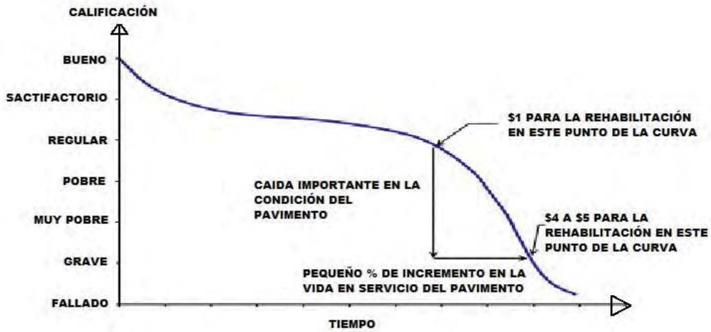
Figura 6-2-1. Condición del pavimento durante su vida útil
