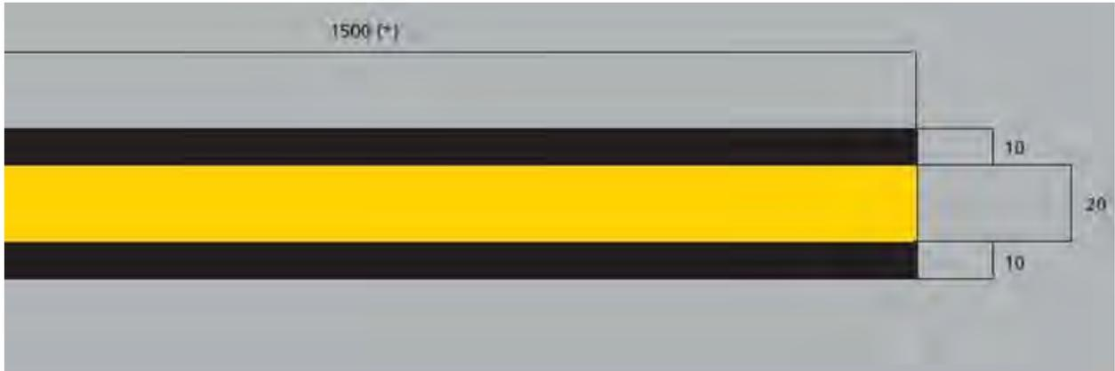
Figura C - 38 Dimensiones de la barra de alineación.
