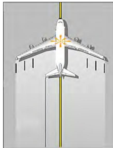
**Figura ADJ A-6. Distancia de precaución cuando la aeronave está en movimiento (Aeronaves convencionales 75m - Fuselaje ancho 125m)**
